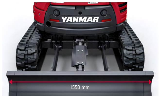
Uitgeschoven: verhoogde stabiliteit voor verbeterde graaf- en laadprestaties
