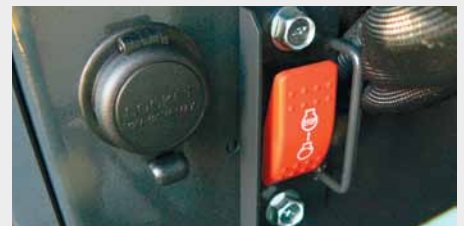
Elektrische uitschakeling van de motor (noodstop)
