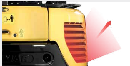
Naar boven gerichte uitlaat van de motor (bescherming van personen planten in de omgeving)
