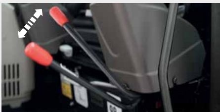
Veiligheidshendel voor toegang tot de bestuurdersplaats
