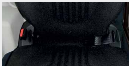
Veiligheidsgordel met rolmechanisme
