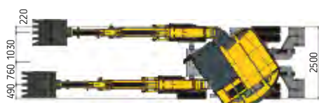
Afb. 1: Uitgraving binnen de gehele breedte van de machine
