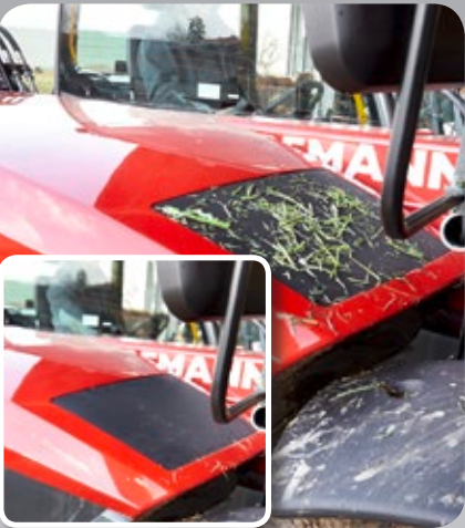
Omkeerventilator (optie voor T6027). Met de omkeerventilator kan, bijvoorbeeld bij het laden van stro, vervuiling van het ventilatierooster tegengegaan worden. De hydraulische motor en pomp zijn zodanig ontworpen, dat de luchtstroom van de ventilator omgekeerd kan worden (omkeermogelijkheid). Door in de cabine op een knop te drukken, wordt het vuil op de zuigerplaten van de motorkap gemakkelijk weggeblazen.
