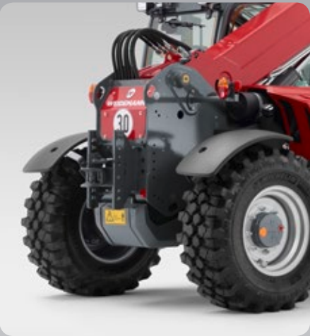
Geschikt voor aanhangerbijrij. Optioneel zijn er verschillende aanhangerkoppelingen verkrijgbaar: van een gemakkelijke rangeerkoppeling en een halbautomatische koppeling tot een Auto-Hitch aanhangerkoppeling* (uiteenlopende beschikbaarheid afhankelijk van het model en land).
