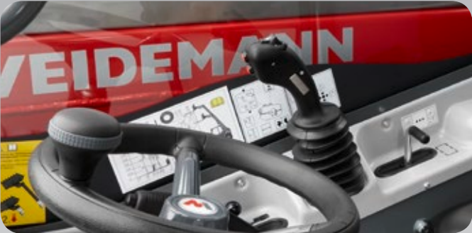
De stuurhendel van de T4512. Met de stuurhendel bestuurt u de hele machine. Robuuste en fijngevoelige besturing voor alle hef- en neerlaatbewegingen en het in- en uitklappen van het aanbouwdeel met slechts één hendel. Optioneel kan de stuurhendel met andere functies worden uitgebreid.
