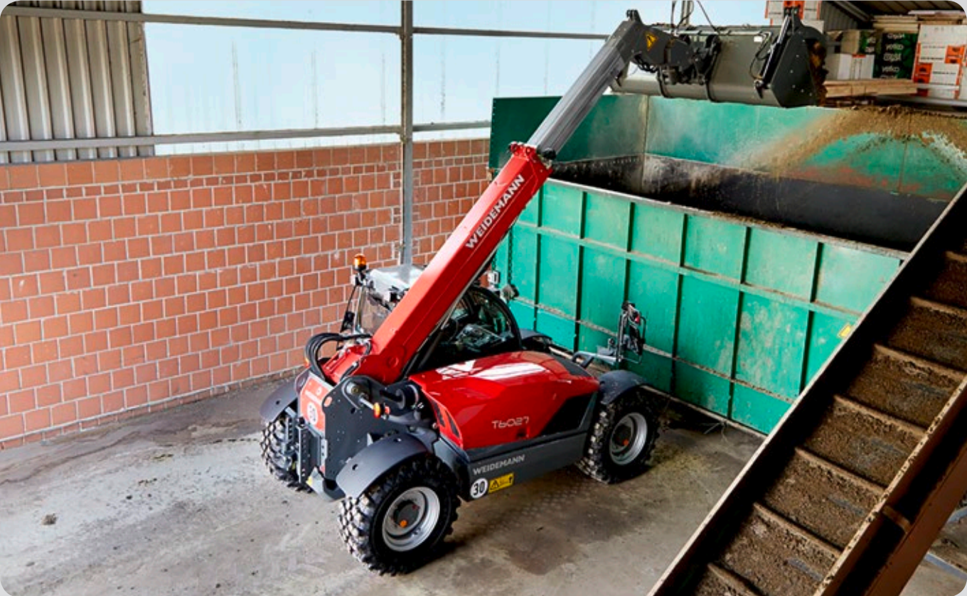
Automatische terugschuifmechanisme (optie voor T6027). Door de betreffende toets op de stuurhendel in te drukken, kan de positie van de opname opgeslagen worden. Bij het volgende laadproces kan zo het aanbouwdeel in exact dezelfde positie opgenomen worden. Het automatische terugschuifmechanisme zorgt zo voor een surplus aan comfort en snelheid voor de bestuurder bij terugkerende werkzaamheden, zoals het stapelen of vullen van bakken.
