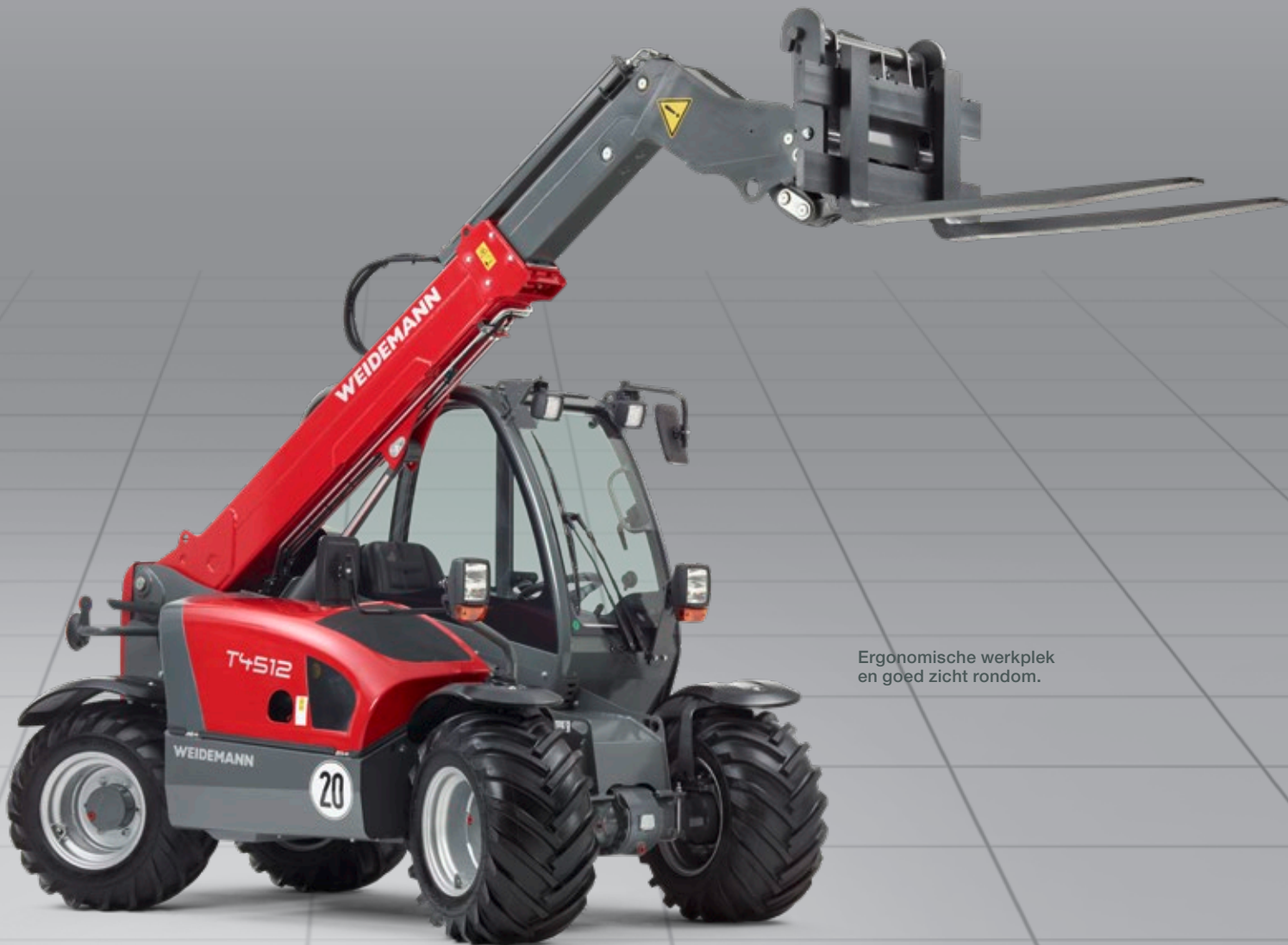
Frame uit één stuk en vierwielbesturing, laag zwaartepunt en uitstekende stabiliteit.
