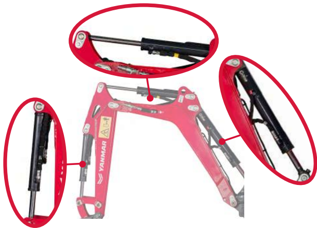
Cilinders boven de giek gemonteerd
