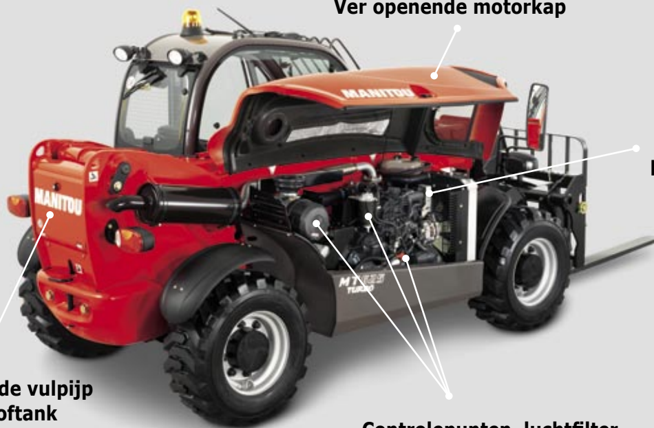
Controlepunten, luchtfilter, brandstoffilter... binnen handbereik
