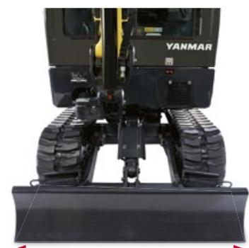
Châssis fermé : **980 mm**
