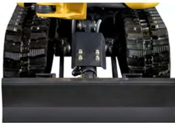
Châssis rétracté 680 mm - Manœuvre aisée
